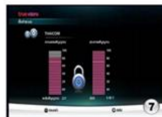
▶ 7. รอสจนกระทั่งปรากฏรูปกุญแจและเลือกสัญญาณ และ มีกดปุ่ม OK เพื่อเริ่มค้นหาสัญญาณ
